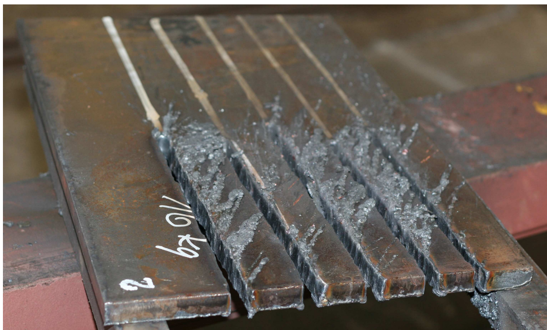
Rys. 4. Wygląd płyty próbnej po cięciu łukowo-powietrznym
