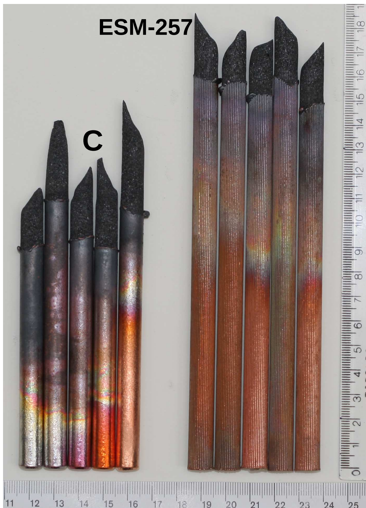
Rys. 16. Wygląd ogarków elektrod grafitowych C oraz ESM-257 o średnicy 10 mm po zakończeniu cięcia łukowo-powietrznego
