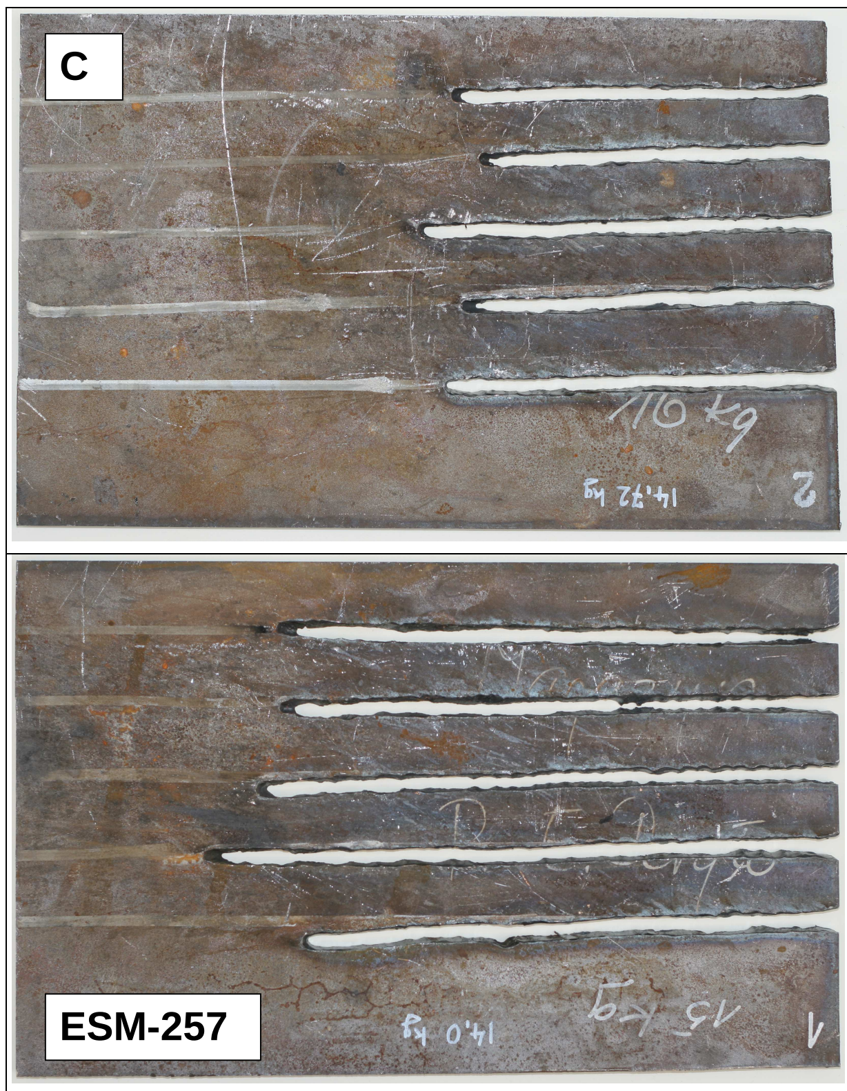
Rys. 5. Wygląd blach ze stali w gat. S355J2 o grubości 15 mm przeciętych z zastosowaniem elektrod grafitowych C oraz ESM-257 o średnicy 6 mm
