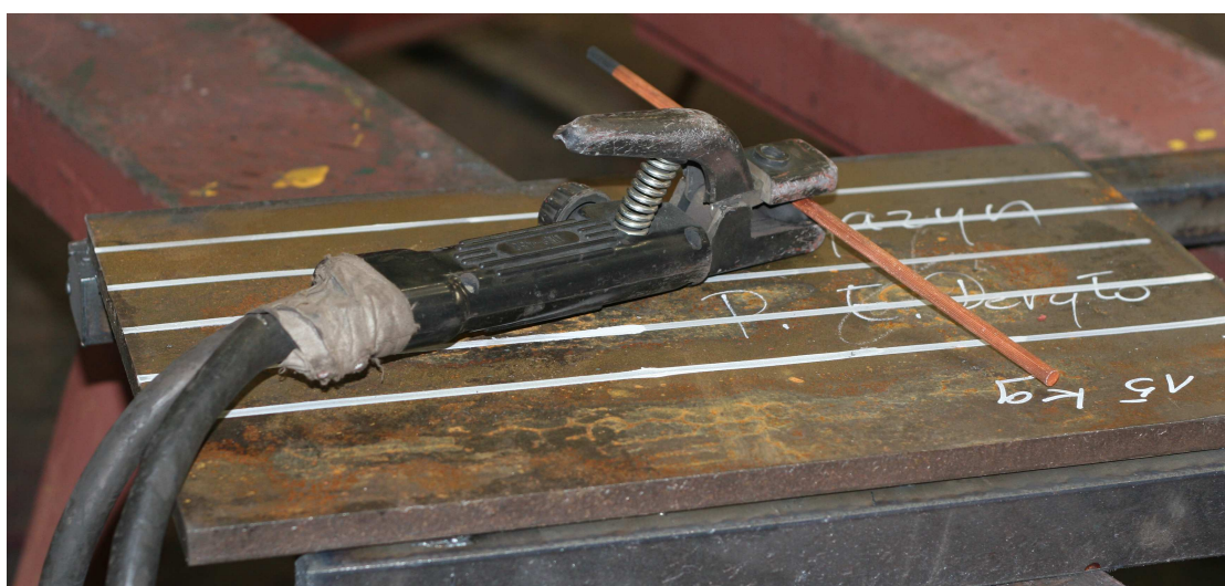
Rys. 3. Wygląd płyty próbnej oraz uchwyty spawalniczego z elektrodą grafitową
