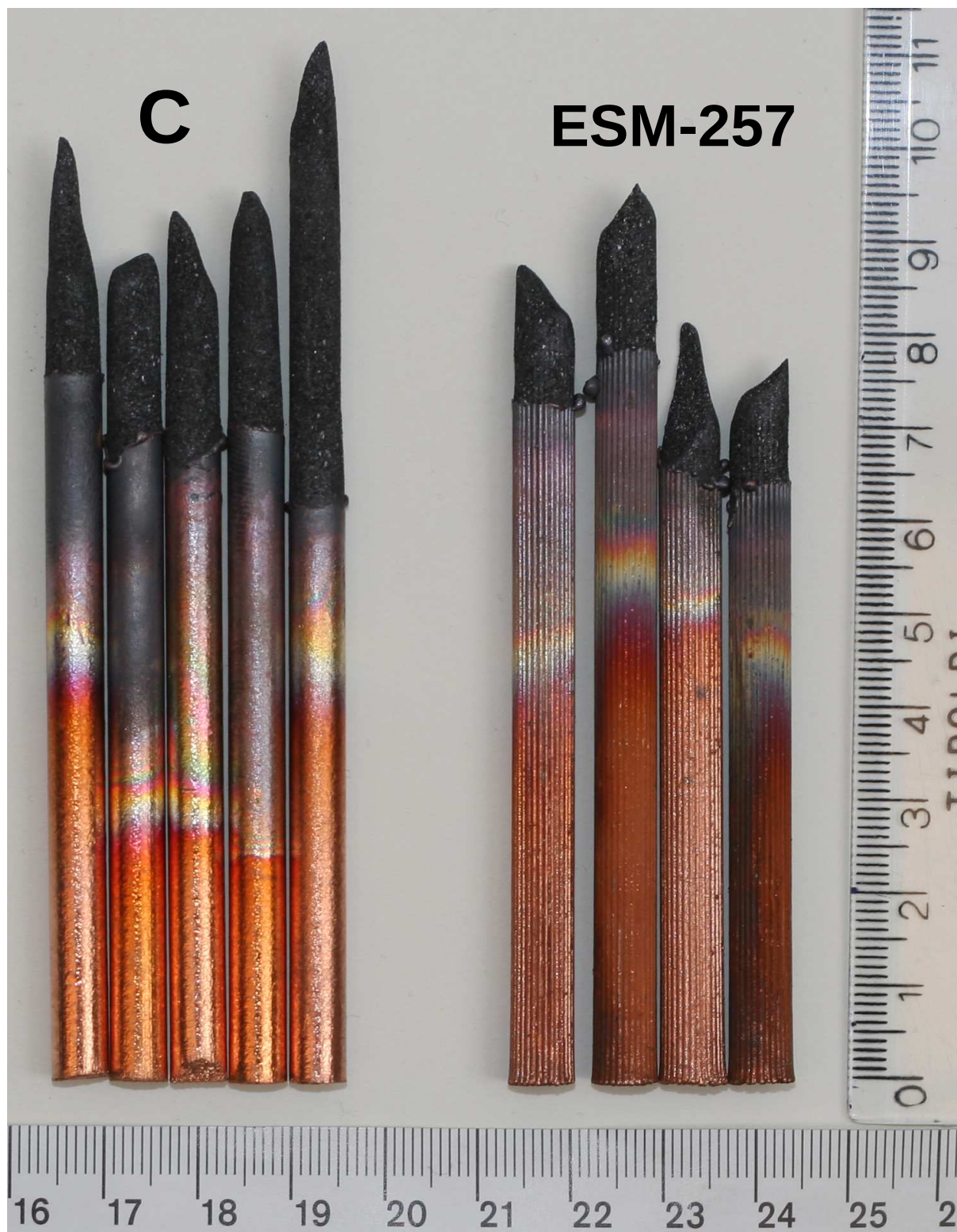
Rys. 14. Wygląd ogarków elektrod grafitowych C oraz ESM-257 o średnicy 6 mm po zakończeniu cięcia łukowo-powietrznego
